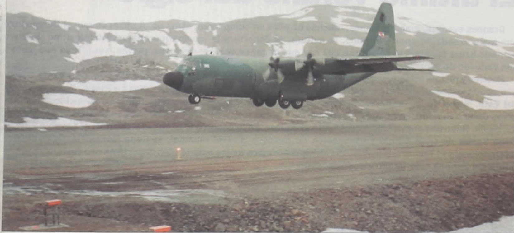
El avión Hércules C-130 de la Fuerza Aérea puede aterrizar en sólo 500 o 600 metros de pista.
