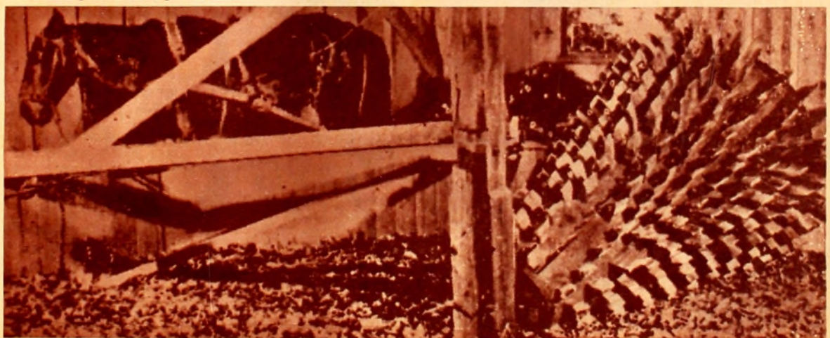
Canchado de la yerba, por el clásico sistema del molino de noria de tracción a sangre. (Foto tomada de Barbosa Lassa).
