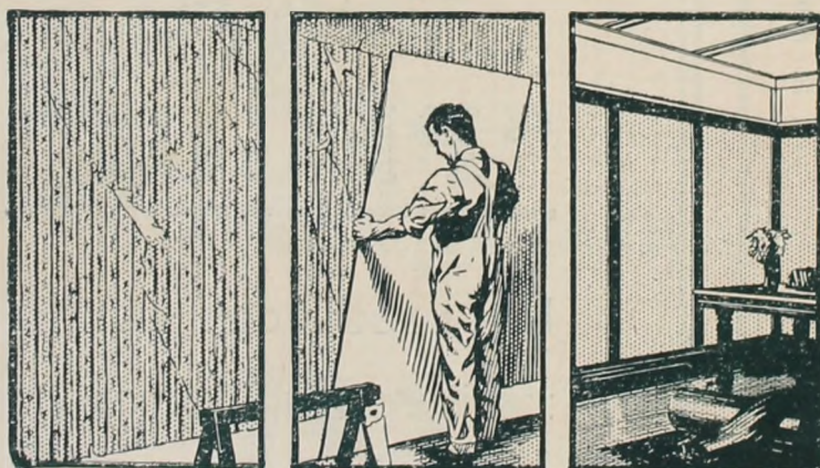
"Beaver Board". — Su colocación
