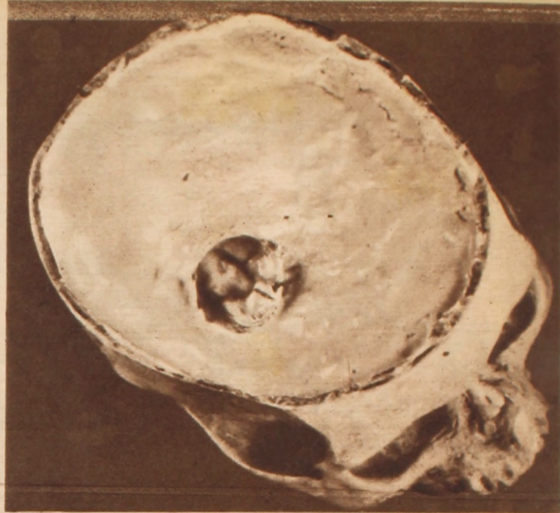
Cráneo lleno de gelatina que por sus condiciones físicas simula el cerebro. El "tumor" está hecho de la misma sustancia; pero con una elevada concentración de elementos radioactivos. Cambiando la posición de este "tumor" apócrifo se han hecho estudios que fueron muy útiles para la neurología.
