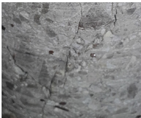
ENSAYO DE COMPRESIÓN DE CILINDRO DE GRC
