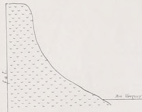
Fig. 9.—Perfil transversal esquemático de la barranca del río Uruguay en la Cabaña "Uruguay", dos leguas al Este de Fray Bentos. f, a, l, formación araucana loessoide. Escala de altura, 1:400.
