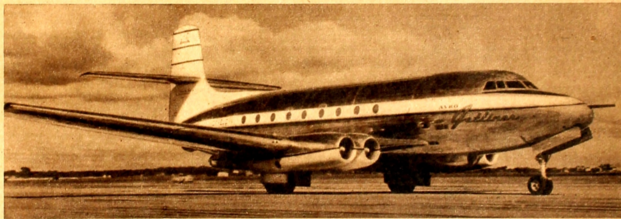
Canadá produce aviones a chorro, tanto para la aviación militar como para el transporte comercial de pasajeros. He aquí a Jetliner, cuádrimotor con capacidad para 40-60 personas, capaz de volar a 800 kilómetros por hora.
