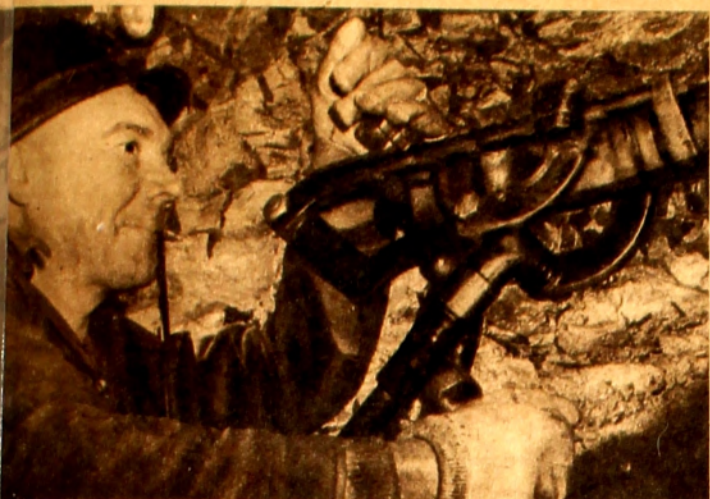
En el Norte de Saskatchewan, este minero utiliza el taladro neumático para extraer el mineral de uranio, materia prima indispensable para la obtención de energía atómica, tanto para fines militares como civiles.
