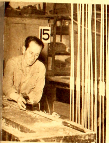
Jabalinas en construcción.
