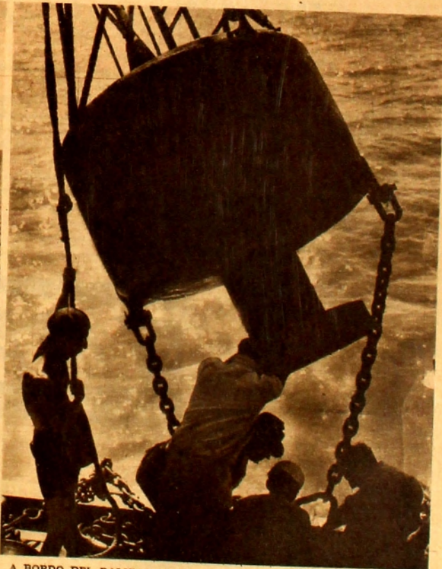
A BORDO DEL BALIZADOR "C.9" — UNA BOYA LEVANTADA POR EL GUINCHE PARA PROCEDER A LA REVISIÓN DE LAS CADENAS QUE LA MANTIENEN ANCLADA.
