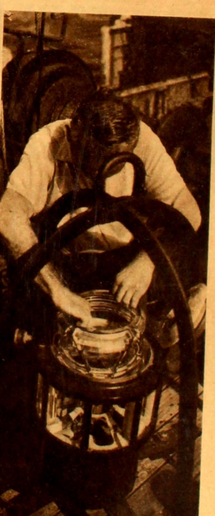
GRATEROLA, EXCELENTE OBRERO DEL SERVICIO DE ILUMINACION Y BALIZAMIENTO, PREPARANDO UNA LINTERNA DE BOYA
