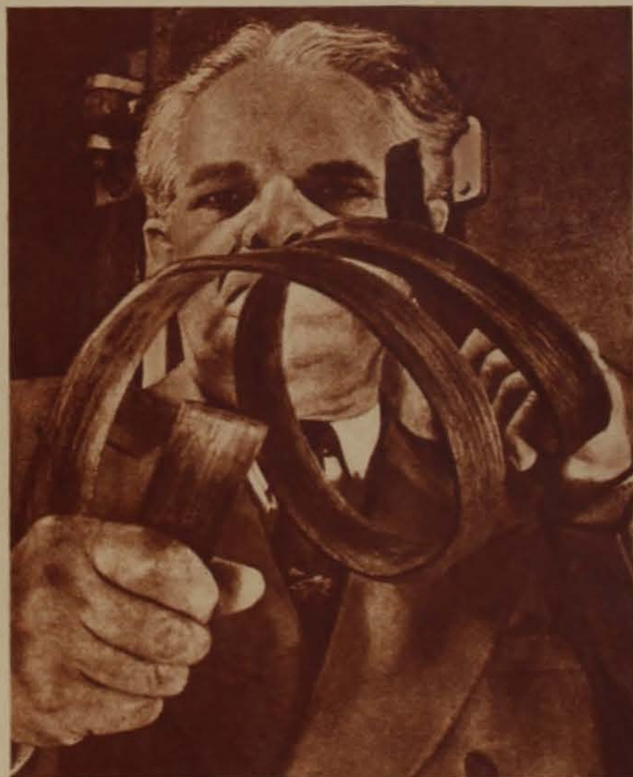
Luego de un tratamiento especial, este pedazo de madera puede ser elaborado como si realmente fuera caucho de la mejor calidad. Pero, al enfriarse se endurece con la forma que se le dió cuando estaba caliente.
