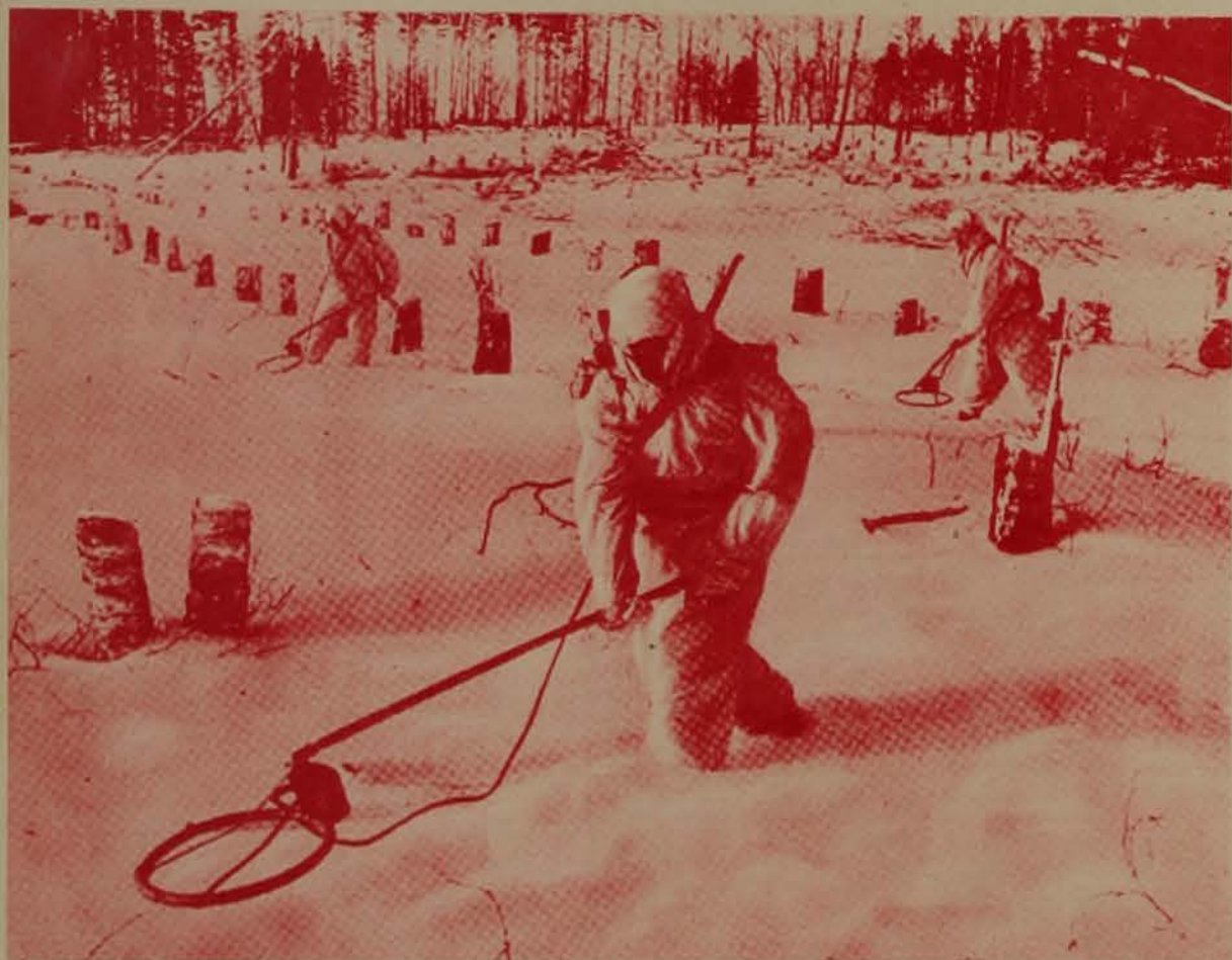
Sin alcanzar los objetivos propuestos, los nazis ven otra vez la llegada del invierno ruso. Signo seguro de éste y de nuevos avances soviéticos es la aparición del buscador de minas. El campo eléctrico del anillo es perturbado por la proximidad de metales.
