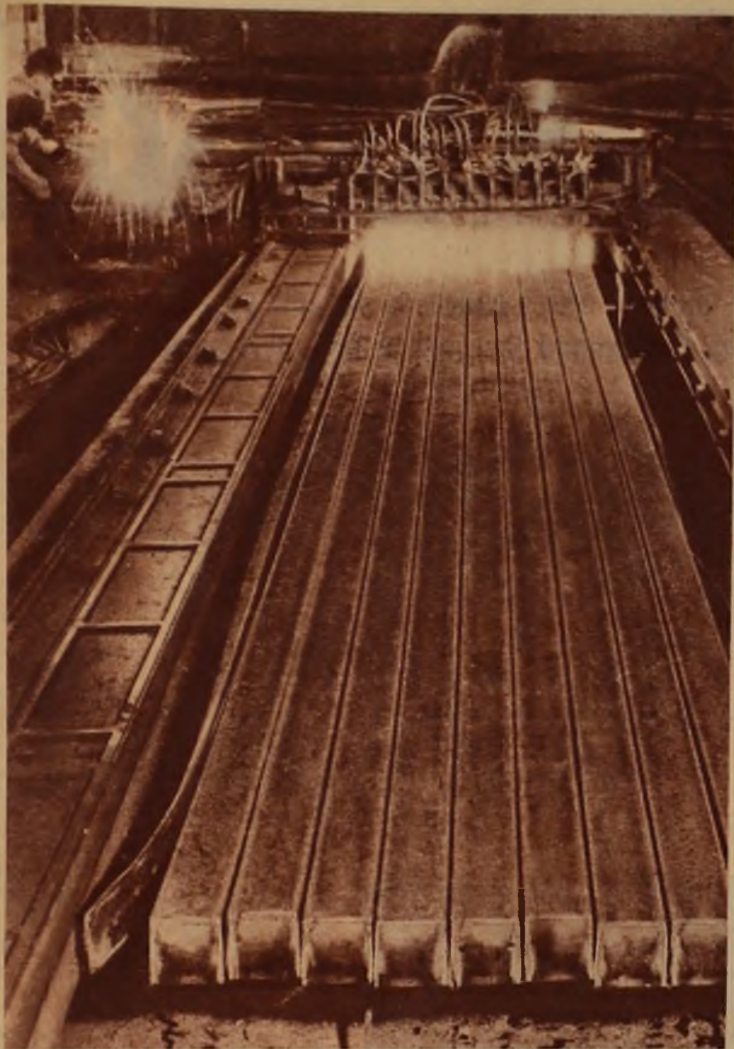
En esta gran chapa de acero, que parece una pista de carreras, nueve sopletes montados en un Arco Radiograph, cortan en otras tantas partes iguales el duro material para uso de guerra, con un 30 % de mayor velocidad en la obra.
