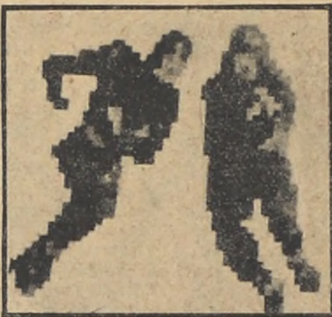
Descomposición de una imagen en 2000 puntos luminosos de intensidad diferente para ser transmitida por televisión
