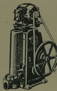
Cabeza de bomba con lubricación automática, ideal para pozos profundos.
